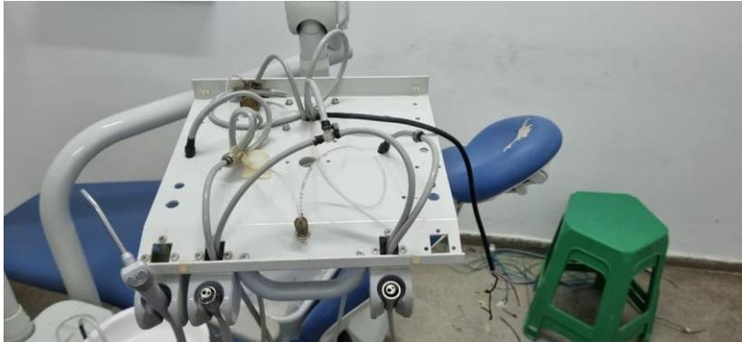
Equipo substituído 5mt de mangueira, feita limpeza e regulagem da válvula de alta, e válvula interruptora revisado Ok
