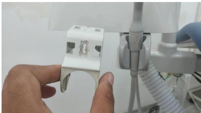
**Feito a substituição do suporte da válvula interruptora**
