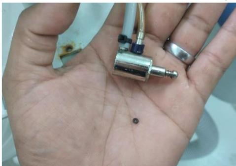
**Válvula interruptora feito reparo substituindo oring**
