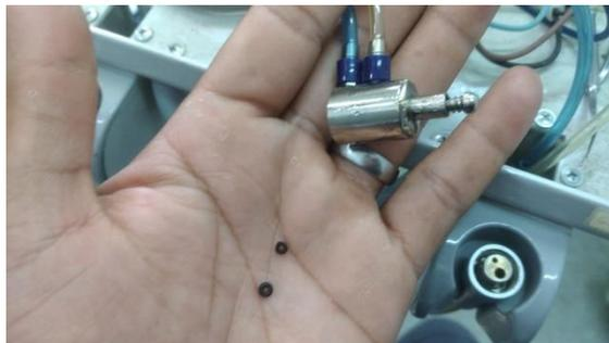
**Equipo feito reparo na válvula interruptora substituído dois oring**
