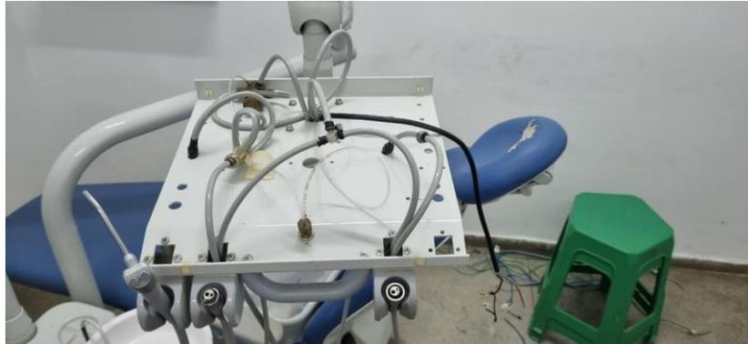
Equipo substituído 5mt de mangueira, feita limpeza e regulagem da válvula de alta, e válvula interruptora revisado Ok
