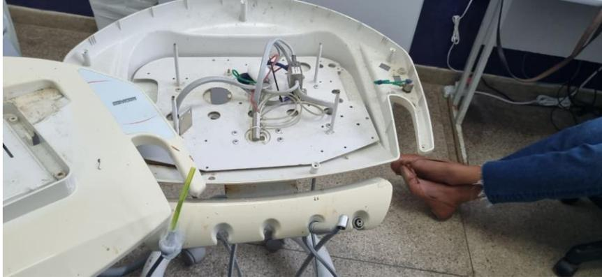
Equipo, feita limpeza e regulagem válvula de alta rotação, retirado vazamento do terminal de alta revisado Ok
