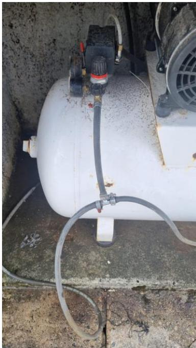
**Compressor substituído conector da mangueira de compressor revisado Ok**
