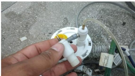
**Substituído válvula de sucção**
