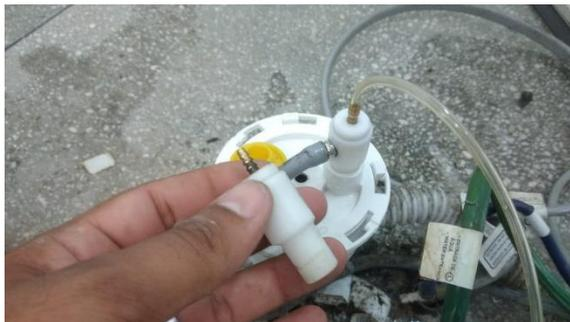
**Substituído válvula de sucção**
